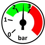
Если для опрессовки труб требуется более высокое давление, запорные клапаны групп климатических панелей должны быть полностью закрыты.
